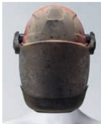
După un arc electric de 7 kA
