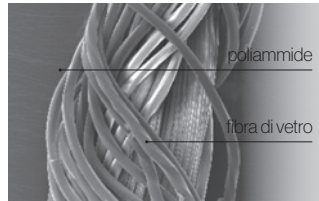
Struttura ottimale: anima – mantello – filato.
