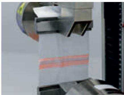
Per la prova di resistenza delle cuciture secondo la norma EN ISO 13935-2 si rileva mediante trattore la forza necessaria per strappare le cuciture.
