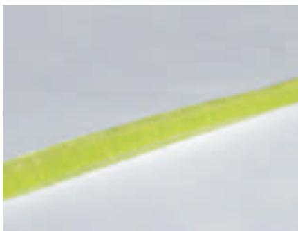
Per garantire la massima tenuta della tuta, l'impuntura è rivestita con un nastro profilato di un colore a contrasto. La variante indicata è disponibile per la tuta monouso uvex 5/6 comfort. Il rivestimento delle impunture mediante nastro profilato garantisce una maggiore tenuta della cucitura.
