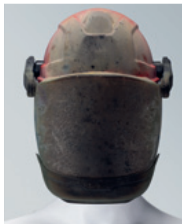
Po 7 kA rušivého elektrického oblouku
