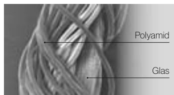
Guter Aufbau. Kern – Mantel – Garn.
