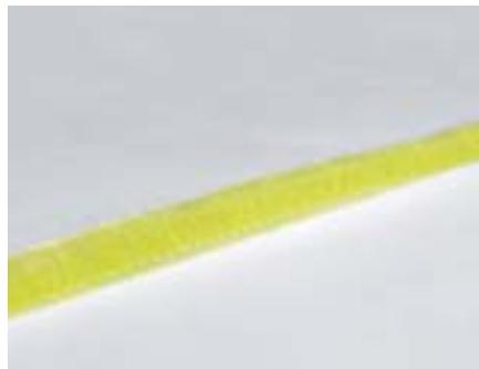
Damit der Overall perfekt dicht ist, wird die Steppnaht mit einem Einfassband in Kontrastfarbe abgedeckt. Diese Variante wird beim Einwegoverall uvex 5/6 comfort eingesetzt. Durch die Abdeckung der Nadeleinstiche mit dem Einfassband wird eine höhere Dichtigkeit der Naht erzielt.
