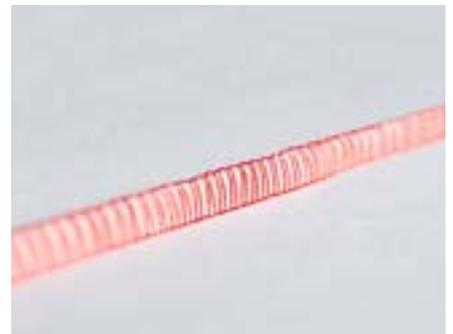
Die innenliegende Overlock-Naht ist bis zu 50% belastbarer und elastischer als die Steppnaht. Sie wird bei den Modellen uvex 5/6 classic, uvex 5/6 air und uvex 5/6 FR verwendet.
