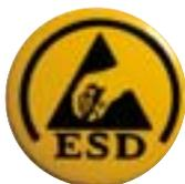
ESD bezeichnet die kontrollierte Ableitung elektrostatischer Energie, die bei unkontrollierter Entladung elektronische Bauteile schädigen oder Explosionen auslösen kann. Mit dem ESD-Symbol gekennzeichnete Sicherheitsschuhe erfüllen die ESD-Vorgabe mit Ableitwiderstand kleiner 35 Megaohm. Detaillierung siehe Seite 264.
