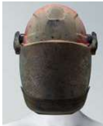
Nach 7 kA Störlichtbogen
