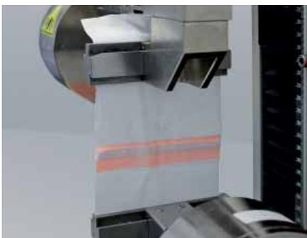
Zur Prüfung der Nahtfestigkeit nach EN ISO 13935-2 wird mit Hilfe einer Zugmaschine die Kraft gemessen, die benötigt wird, um die Naht zum Reißen zu bringen.
