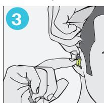
3 Insérez les bouchons uvex et maintenez-les brièvement. L'ajustement est parfait lorsque les bouchons ne sont pas visibles de face.
