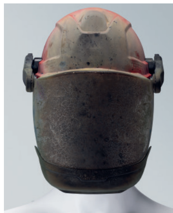
Nach 7 kA Störlichtbogen
