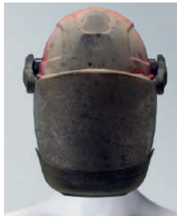
Nach 7 kA Störlichtbogen
