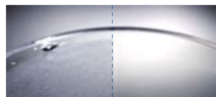
Traitement anti-buée uvex ETC classique après 8 secondes
