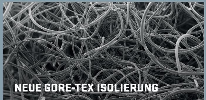
Hohle und weniger Fasern reduzieren das Gewicht = **15% leichter** | die 3D-Struktur ermöglicht die Speicherung von mehr Luft für eine **bessere Isolierung** | der Spiraleffekt sorgt für Flexibilität und Komfort.
