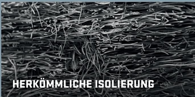
Festere Fasern **erhöhen das Gewicht** | die flache 2D-Schichtstruktur **verhindert das Eindringen von Luft** | **Verlust der Isolierfähigkeit** bei Komprimierung | die Fasern verbinden sich und **beeinträchtigen so die Flexibilität**.
