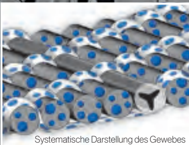
Systematische Darstellung des Nega-Stat®-Garnes
