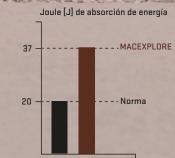
absorción de energía especificada por la norma EN ISO 20345
