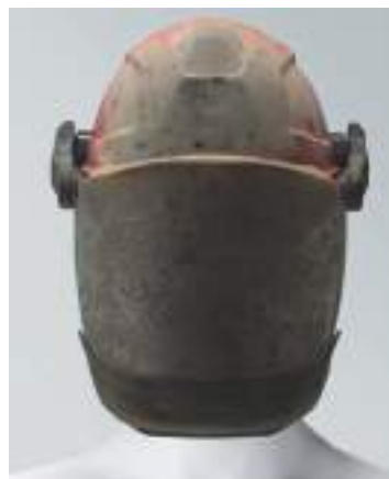
Después de una descarga de un arco eléctrico de 7 kA
