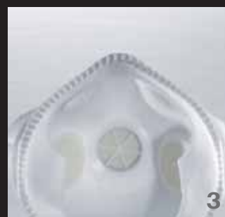
3 Veľké vdychovacie ventily umožňujú veľmi nízky odpor pri vdychovaní
