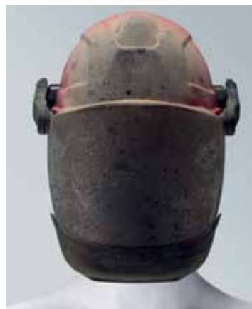
Po zásahu rušivý elektrickým oblúkom 7 kA
