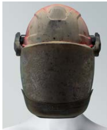
Po 7 kA rušivého elektrického oblouku
