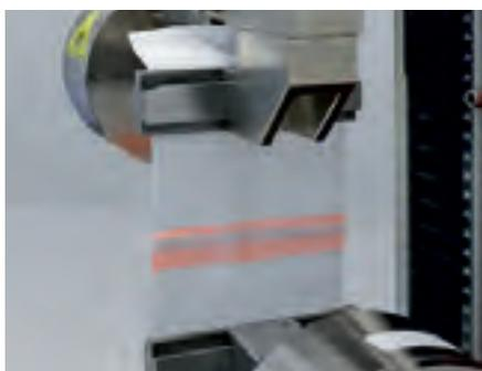
Pour contrôler la solidité des coutures selon la norme EN ISO 13935-2, la force nécessaire pour déchirer les coutures est mesurée à l'aide d'une machine de traction.
