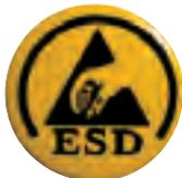
ESD désigne les décharges contrôlées d'énergie électrostatique qui peuvent endommager les composants électroniques ou déclencher des explosions en cas de décharge incontrôlée. Les chaussures de sécurité portant le symbole ESD respectent les spécifications ESD avec une résistance électrique inférieure à 35 mégaohms. Pour une explication détaillée, voir page 244.
