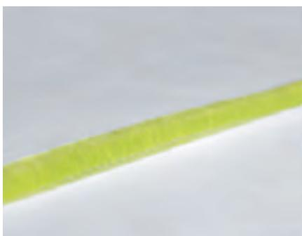
Afin de garantir une étanchéité parfaite, la ligne de piqûre est recouverte d'une bande de bordure dans une couleur qui contraste. Cette variante est utilisée dans la combinaison à usage unique uvex 5/6 confort. Recouvrir les points d'aiguille par la bande de bordure permet d'obtenir une meilleure étanchéité.
