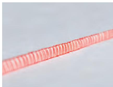
La couture overlock intérieure est jusqu'à 50 % plus résistante et plus élastique que la ligne de piqûre. Elle est utilisée dans les modèles uvex 5/6 classic et uvex 5/6 air.
