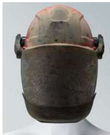
Po 7 kA rušivého elektrického oblouku
