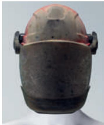
Después de la descarga del arco eléctrico de 7 kA
